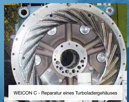
Durch Kavitationsschäden und Lochfraß stark beschädigte Turbine aus hochlegiertem Stahl
